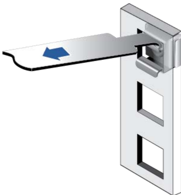
图 5-5 在机柜中安装浮动螺母
