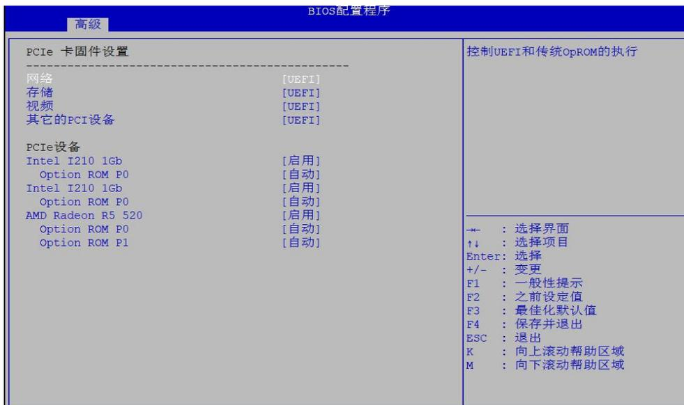
图 3-20 PCIe 设备配置界面
