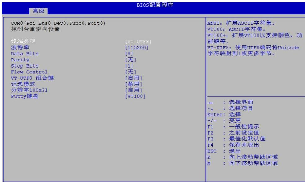
图 3-10 (COM0)控制台重定向配置界面
