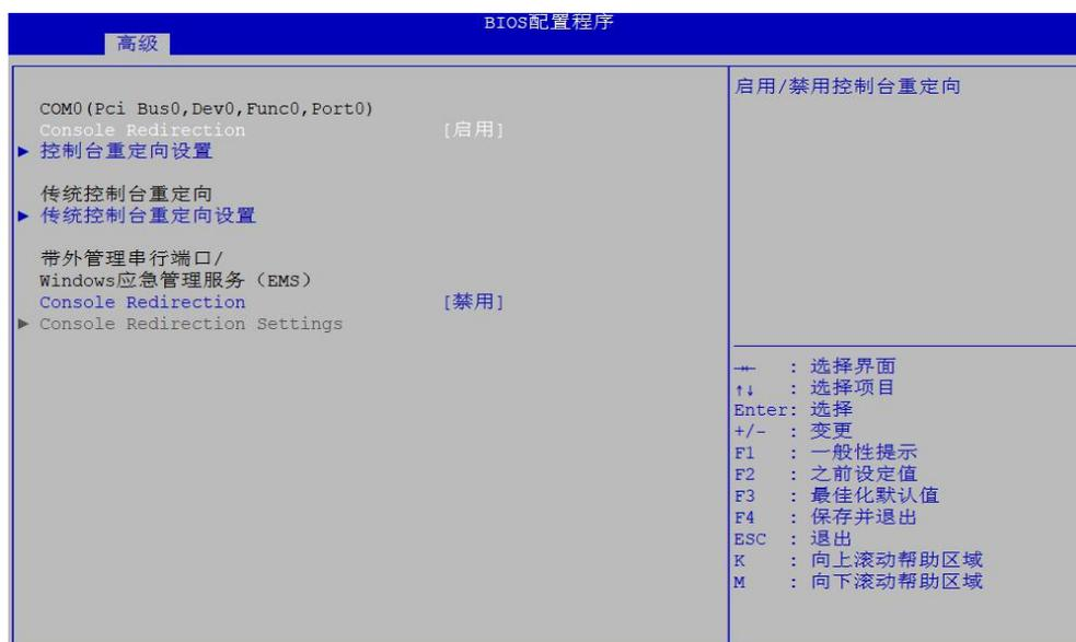
图 3-9 串口控制台重定向配置界面
